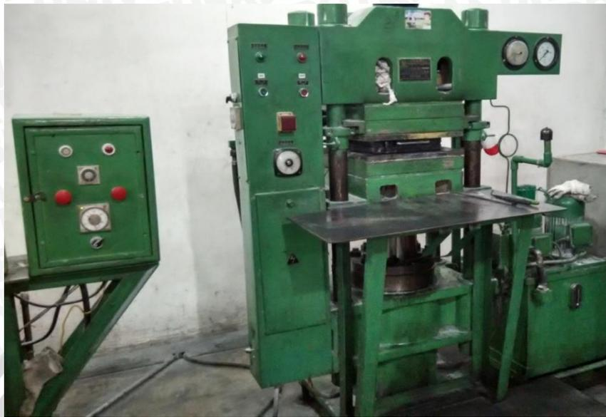
Gambar 4.20 Mesin Pencetak Pentil dan *Tire valve*
