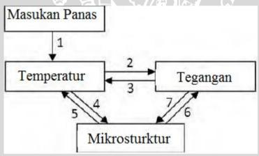
Gambar 2.14: Hubungan masukan panas dengan parameter lain dalam pengelasan
