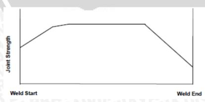
Gambar 2.5 Variasi kekerasan sepanjang sambungan Butt pada FSW
