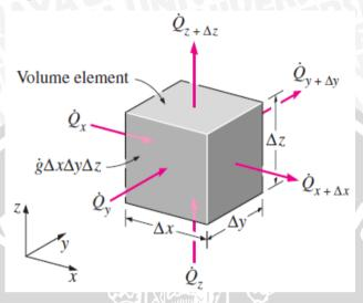
Gambar 2.10 : Konduksi panas tiga dimensi pada elemen volumetrik
