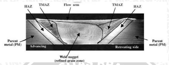
Gambar 2.2 Heat Zone pada FSW
