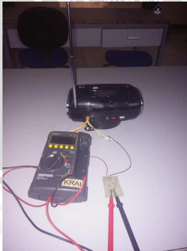
Gambar 4.5 Pengujian Rangkaian Rectenna Tanpa Menggunakan Switching Mode
