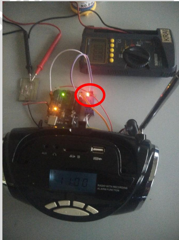
Gambar 4.9 Pengujian Rangkaian Rectenna dengan Menggunakan Switching Mode dan Keadaan Radio Nyala
