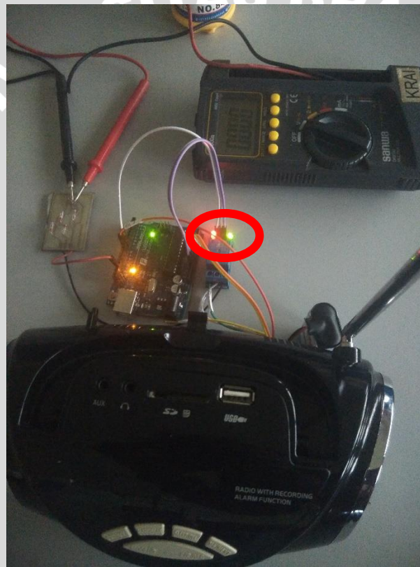
Gambar 4.7 Pengujian Rangkaian Rectenna dengan Menggunakan Switching Mode dan Keadaan Radio Mati
