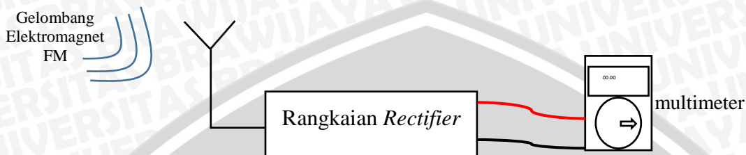
Gambar 4.1 Skema Pengujian Tegangan DC Rangkaian Rectenna Tanpa Menggunakan Switching Mode
