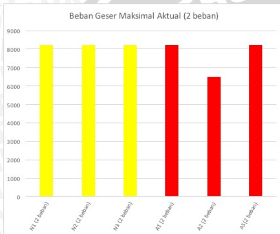
Gambar 4. Grafik Perbandingan Beban Geser Maksimal Aktual Beton Normal dengan Beton Ringan yang Diberi 2 Beban Terpusat
