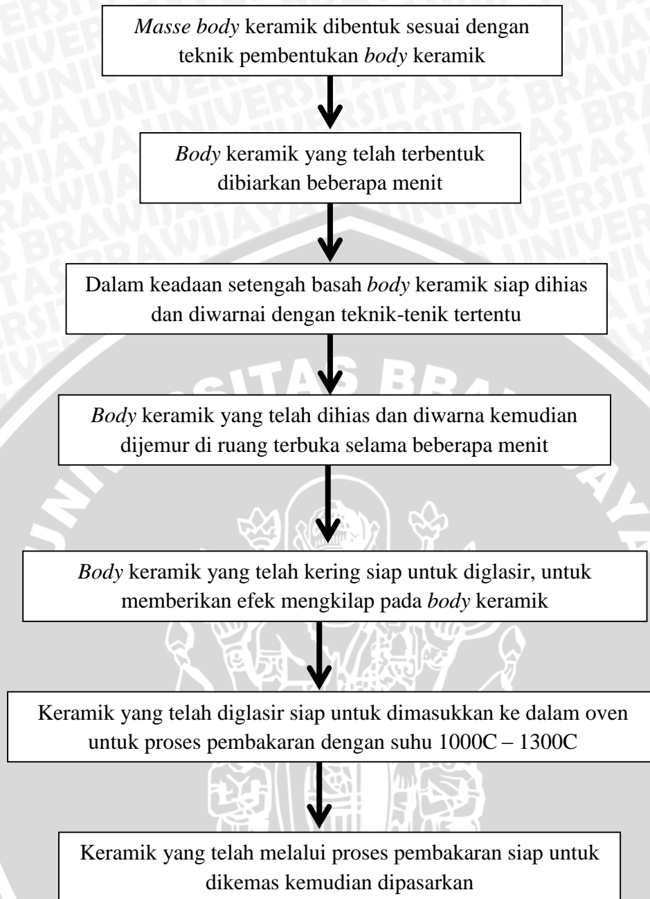
Gambar 2. 2 Tahapan Pembuatan Keramik Menjadi Barang Jadi
