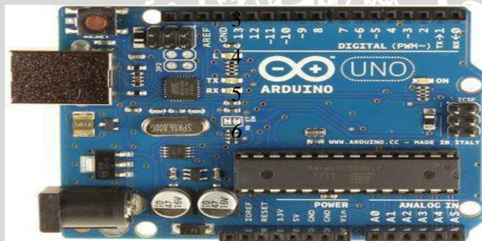
Gambar 2. 8 Arduino UNO R3 (Sumber: Arduino, 2009)
