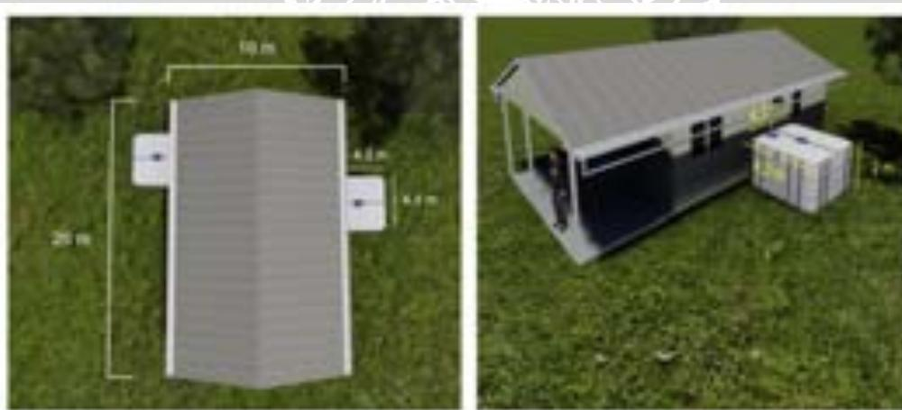
**Gambar 4.50 Tampak Atas dan Tampak Samping Peletakkan Tangki Rain Harvesting Pada Rumah Besar (20m x 10m)**
