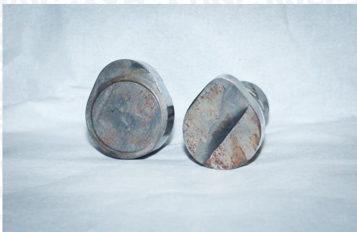
Gambar 1 benda kerja layer 0mm sebelum (kiri) dan benda layer 2mm sesudah (kanan)
