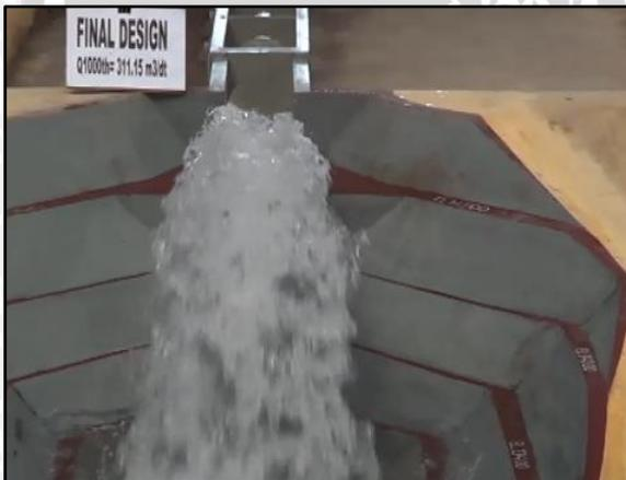
Gambar 9. Kondisi aliran di peredam energi pada *final design*
