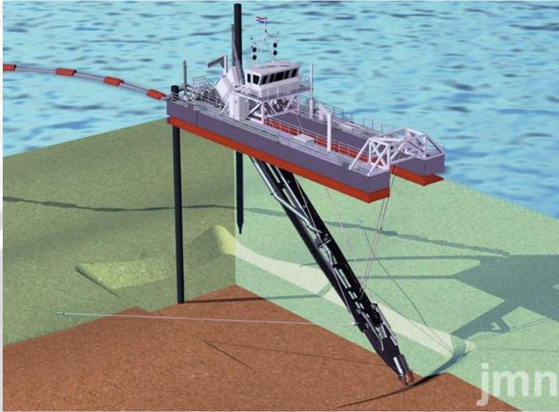
Gambar 4.6 Skema Teknis Kegiatan Pengerukan Sedimen
