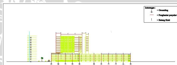
Gambar 4.11 Tampak samping sistem penghantar penyalur pada gedung
