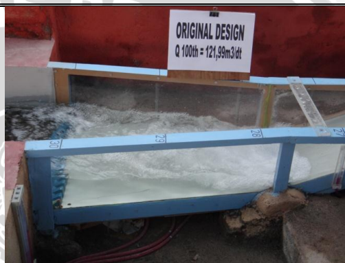
Foto 10. Kondisi aliran pada Peredam Energi
