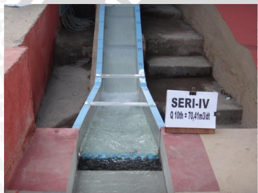
Foto 58. Kondisi Aliran Pada Peredam Energi Debit Q_{10th}
