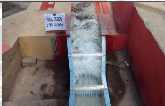
Foto 115. Kondisi aliran pada Peredam Energi
