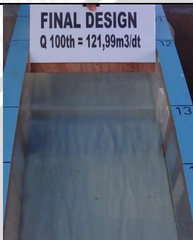
Foto 102. Kondisi aliran pada Saluran Peluncur
