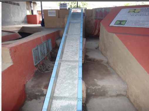
Foto 72. Kondisi aliran pada Saluran Peluncur
