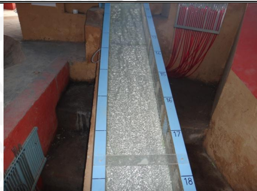
Foto 21. Kondisi aliran pada Saluran Peluncur
