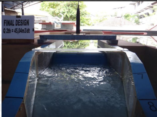
Foto 70. Kondisi Aliran pada Pelimpah
