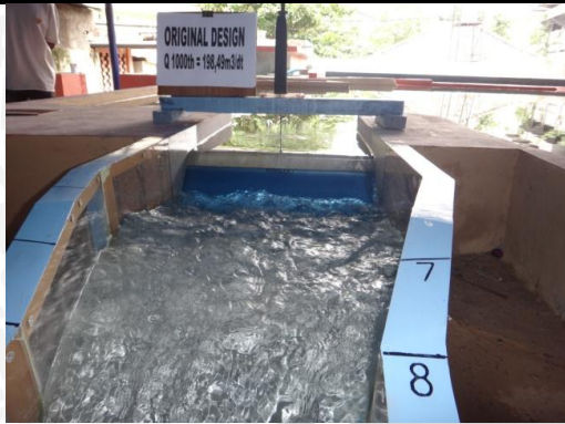
Foto 13. Kondisi Aliran pada Pelimpah
