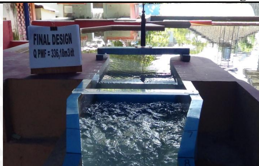
Foto 112. Kondisi Aliran pada Pelimpah
