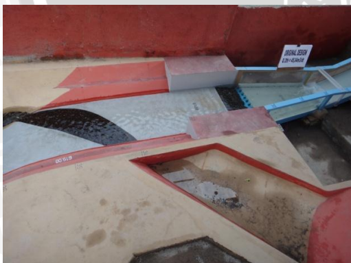
Foto 5. Kondisi aliran pada Saluran Pengarah Hilir
