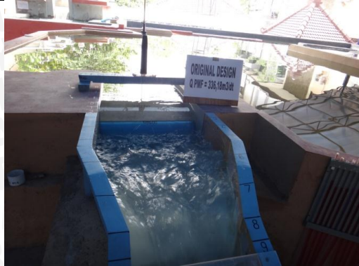
Foto 19. Kondisi Aliran pada Pelimpah
