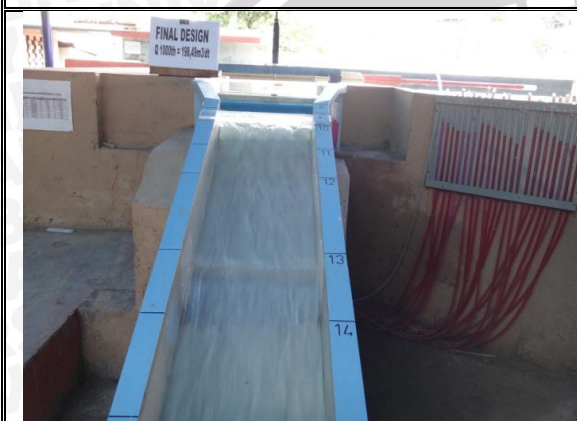
Foto 108. Kondisi aliran pada Saluran Peluncur
