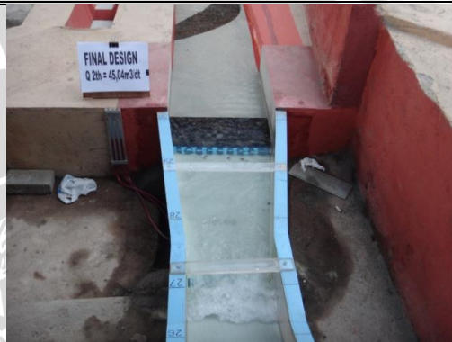
Foto 73. Kondisi aliran pada Peredam Energi
