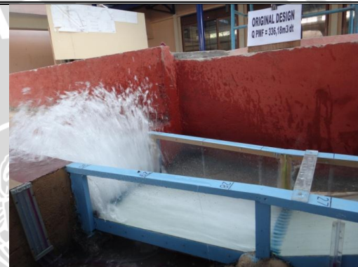
Foto 22. Kondisi aliran pada Peredam Energi
