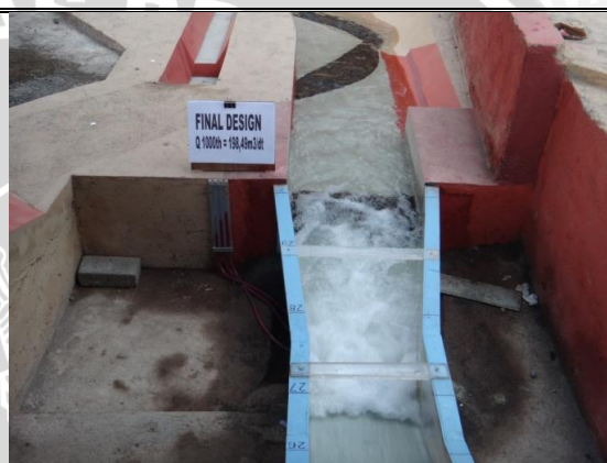
Foto 109. Kondisi aliran pada Peredam Energi
