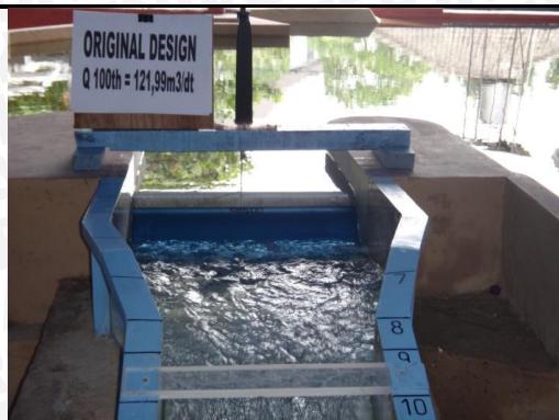
Foto 7. Kondisi Aliran pada Pelimpah
