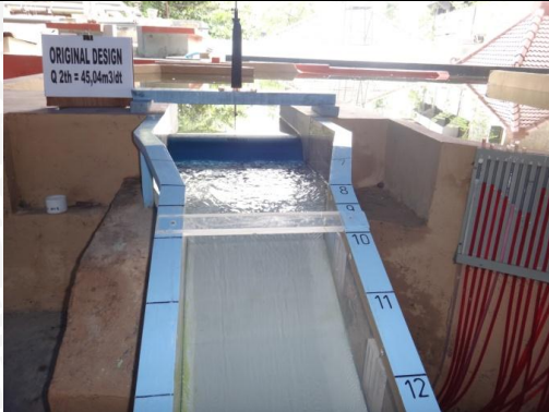
Foto 1. Kondisi Aliran pada Pelimpah
