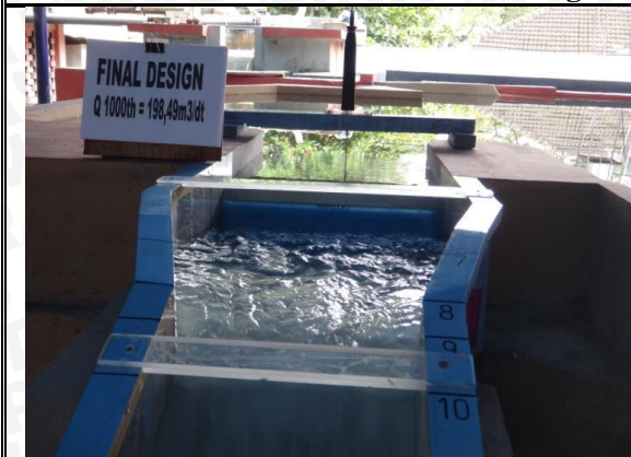
Foto 106. Kondisi Aliran pada Pelimpah
