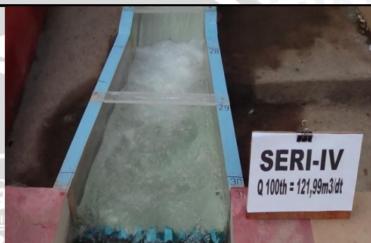
Foto 103. Kondisi aliran pada Peredam Energi
