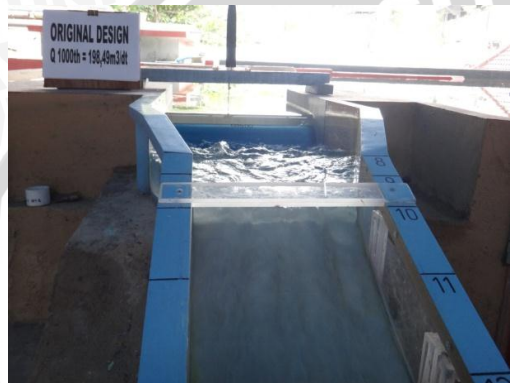
Foto 15. Kondisi aliran pada Saluran Peluncur
