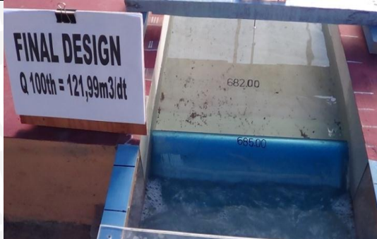
Foto 100. Kondisi Aliran pada Pelimpah
