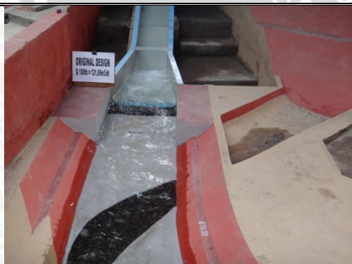
Foto 11. Kondisi aliran pada Saluran Pengarah Hilir
