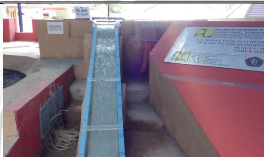
Foto 114. Kondisi aliran pada Saluran Peluncur
