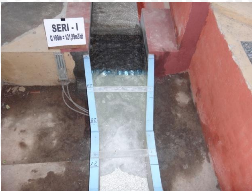
Foto 26. Kondisi Aliran pada Stilling basin Q_{100th}
