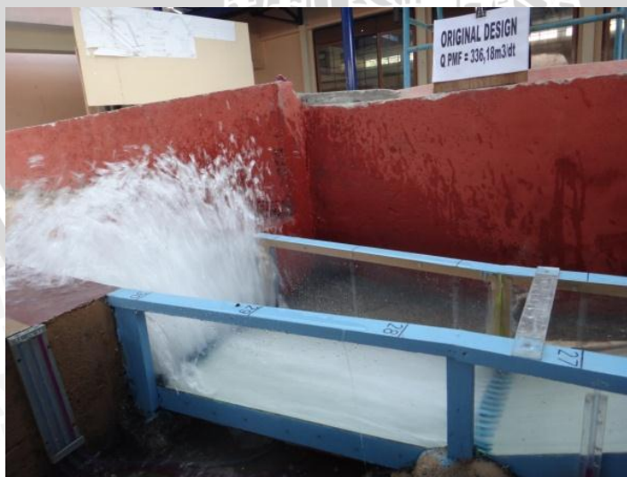
Gambar 1.3 Loncatan hidrolis pada kolam olak debit Q_{PMF} .
