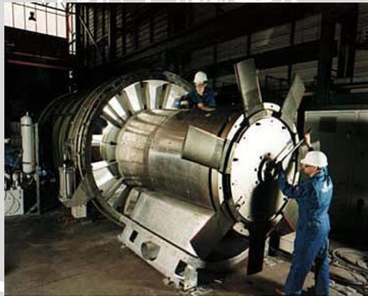
Gambar 2.7 Wells turbin sebelum diletakkan di mesin konversi
