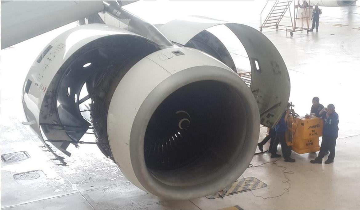
Gambar 2.14 Proses *compressor washing* pada A330
