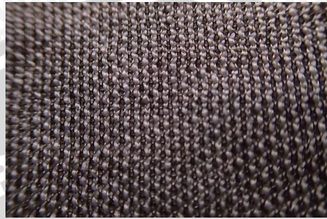
Gambar 4.23 Bahan filter baghouse pada wet scrubber
