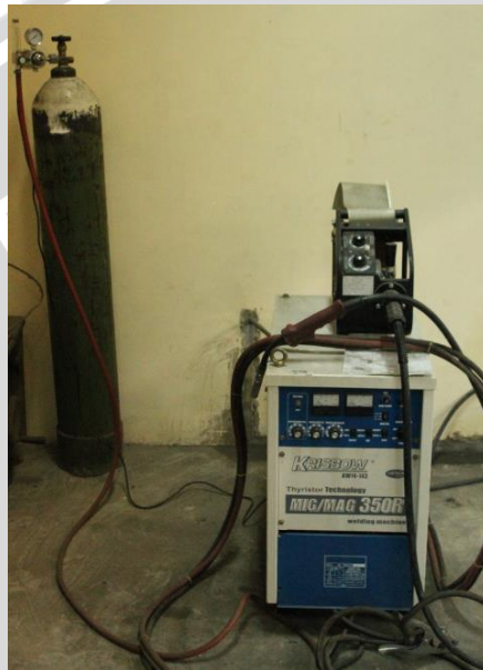
Gambar 3.4 Mesin las MIG Sumber: Dokumentasi Pribadi
