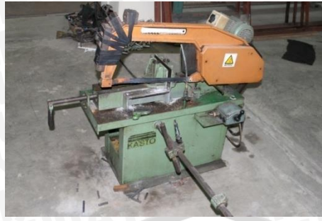
Gambar 3.1 Power hack saw Sumber: Dokumentasi Pribadi
