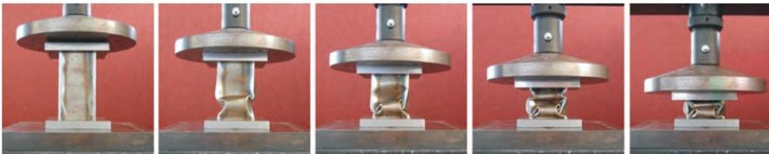
Gambar 2.6 *Axial Crushing Test* pada *Crash Box* Persegi
