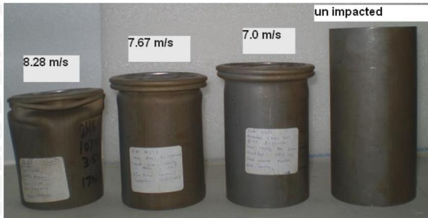
Gambar 2.2 Hasil Pengujian Dinamik Terhadap *Crash Box* Berpenampang Lingkaran
