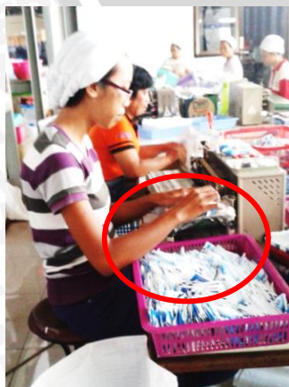
Gambar 4.26 Identifikasi Postur Kerja Pekerja 2 pada Tindakan Teknis Menyegel Plastik Kemasan
