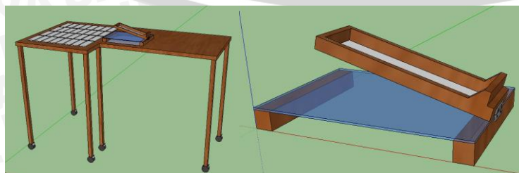
Gambar 4.34 Desain rancang ulang meja sablon dan pengeringan, dan alat sablon
