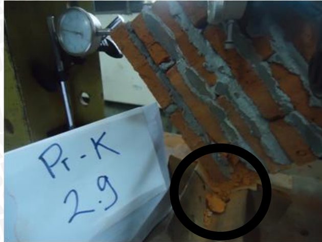
Gambar 4.14. Keruntuhan awal yang terjadi pada tumpuan
