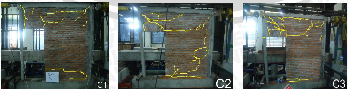
Gambar 4.17 Gambar pola retak pada dinding C (Bukaan Tepi)
