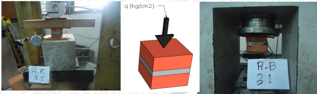
Gambar 4. 11. Konfigurasi Pembebanan pada Prisma Kubus Bata
