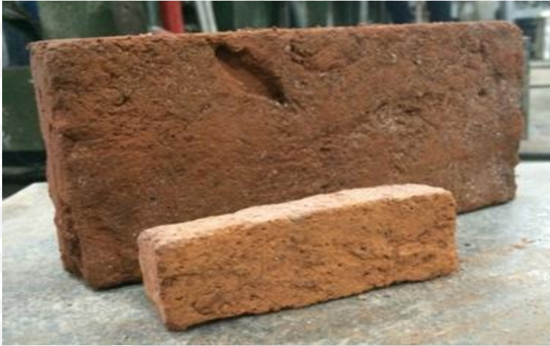
Gambar 4.4. Perbandingan visual bata terskala dan aktual
