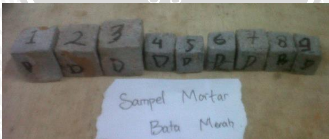
Gambar 4.7 Beberapa sampel mortar.
