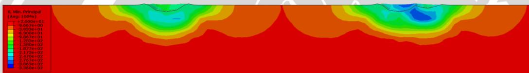
Gambar 4.17 Distribusi tegangan sisa pada material *Stainless Steel*
