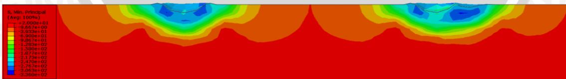
Gambar 4.5 Distribusi tegangan sisa pada material *Carbon steel*.
