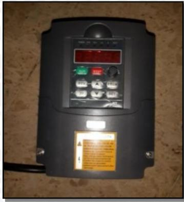
Gambar 9. Bentuk Fisik VFD
