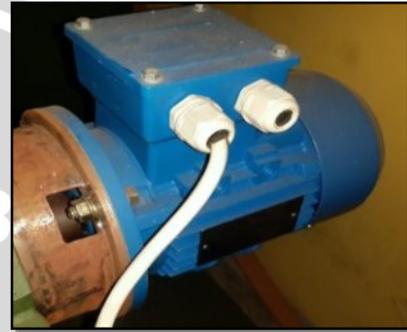
Gambar 7. Motor Induksi 3 Fasa
