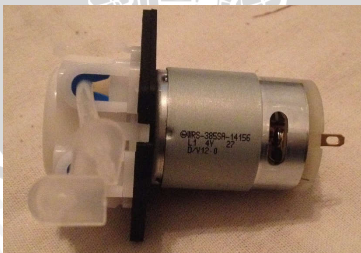
Gambar 4.10 Motor DC dengan Modul Peristaltic Pump
