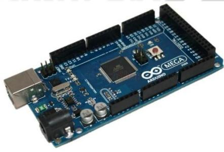
Gambar 16. Modul Arduino Mega 2560 [5]
