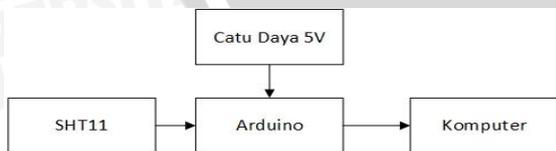
Gambar 17. Blok Pengujian Sensor SHT11 untuk suhu
