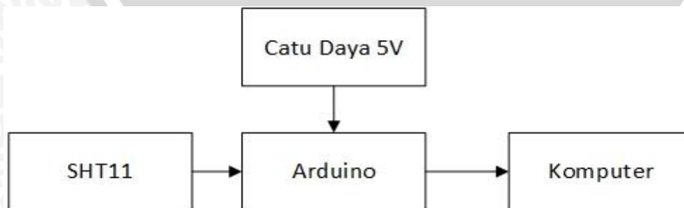
Gambar 5.1 Blok Pengujian Sensor SHT11 untuk Suhu
