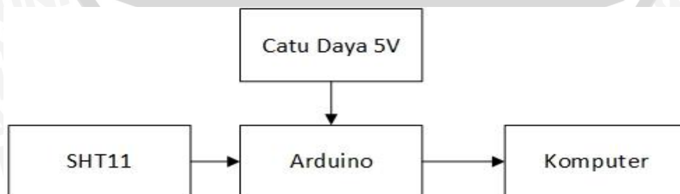
Gambar 5.3 Blok Pengujian Sensor SHT11 untuk Kelembaban
