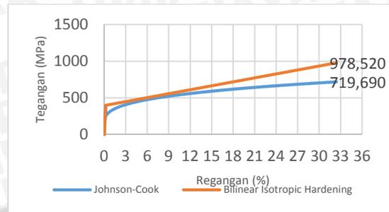
Gambar 10. Grafik Tegangan-Regangan Pada Model Material
