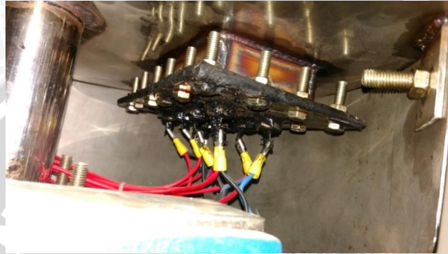
Gambar 4.3 Elemen Pemanas pada Jacket Tabung Evaporator (Perancangan)
