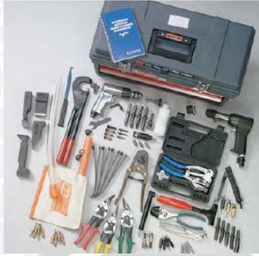
Gambar 2. 22 Alat-alat perakitan pesawat terbang
