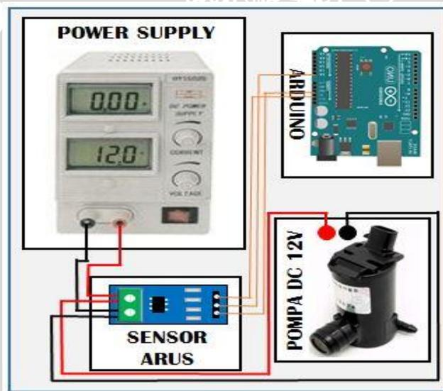
Gambar 3.18 Hasil Pengujian Sensor arus (Perancangan)
