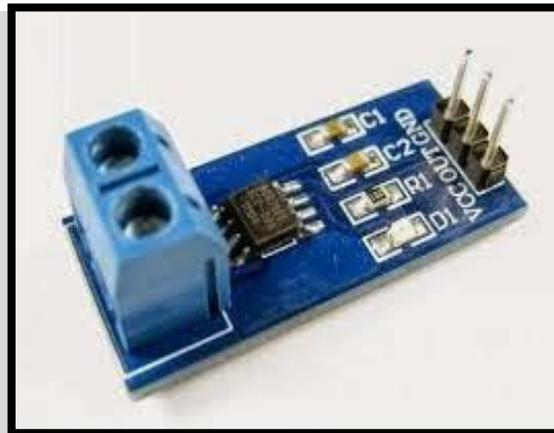
**Gambar 2.16 Sensor Arus ACS 712 5A**
