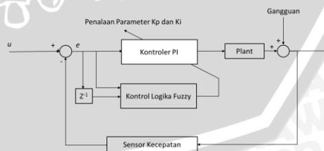
**Gambar 19. Diagram blok perancangan kontroler self-tuning parameter PI**
