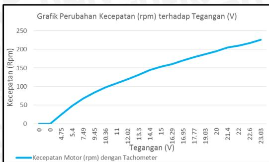
**Gambar 2. Perubahan kecepatan motor terhadap input tegangan**
