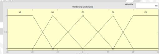
**Gambar 11 Membership function input untuk error**
