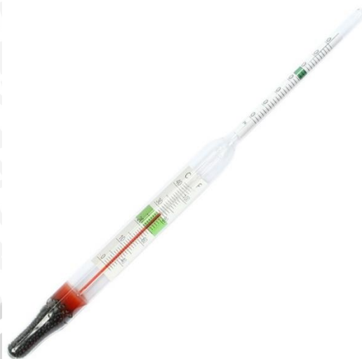
Gambar 2.10 Hidrometer celup (Sumber: www.aliexpress.com/ )
