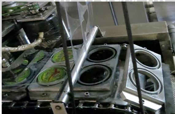
Gambar 4.14 Proses *Cutting* pada *Lid*
