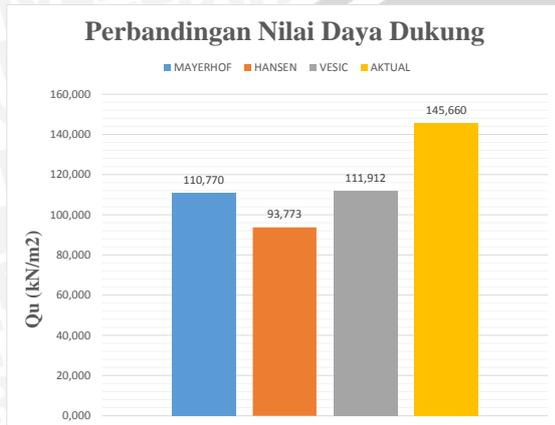
**Gambar 2 .** Perbandingan nilai daya dukung menggunakan rumus tanah pasir tanpa perkuatan
