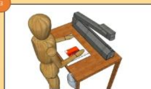
Kiri : Mengatur kemasan lembaran untuk di las Kanan : Mengatur kemasan lembaran untuk di las
