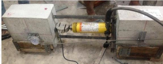
Gambar 4.1 Pengujian Pull Out
