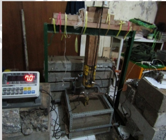
Pembebanan benda uji dengan Hydraulic Jack
