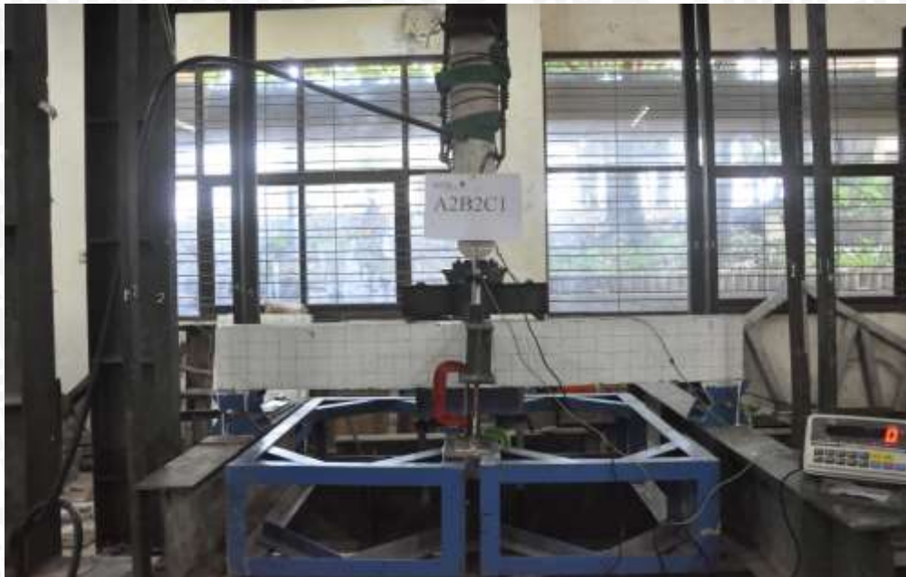
Gambar 4.6 Setting pengujian balok
