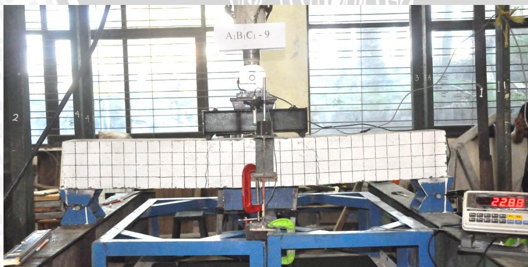
Gambar 4.7 Setting pengujian pembebanan balok
