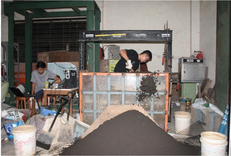
Proses pembongkaran tanah pasir
