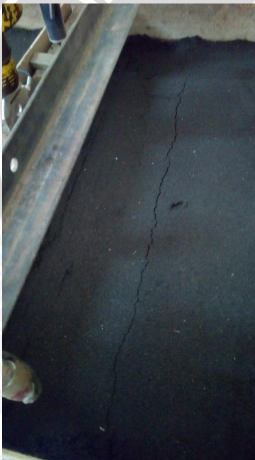
Retakan yang terjadi pada permukaan tanah pasir setelah uji pembebanan.
