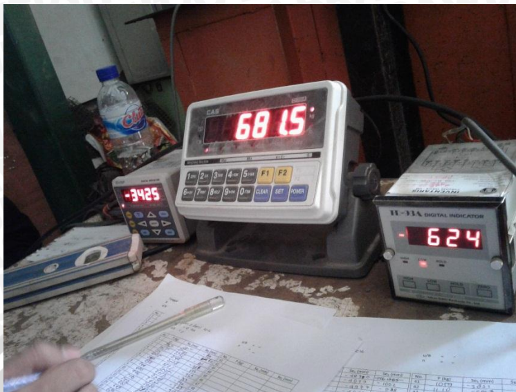
Proses pembebanan dan pembacaan dial LVDT
