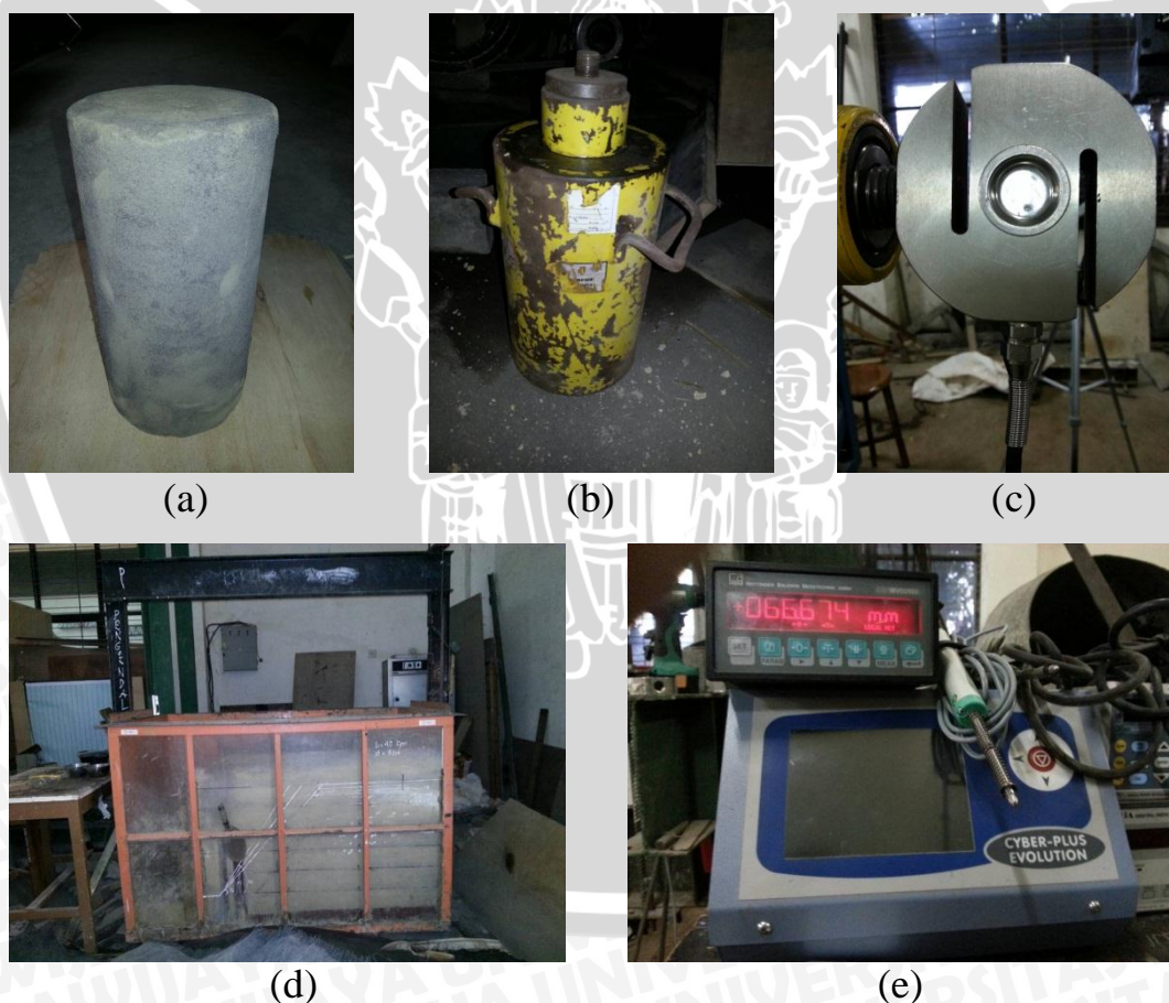
Gambar 3.2 Peralatan yang digunakan dalam penelitian : (a) silinder beton, (b) dongkrak hidrolik, (c) Load Cell , (d) box pengujian dan (e) LVDT
