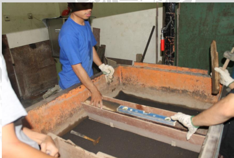
Proses pemasangan pondasi diatas tanah pasir
