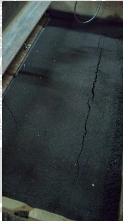
Retakan yang terjadi pada permukaan tanah pasir setelah uji pembebanan.
