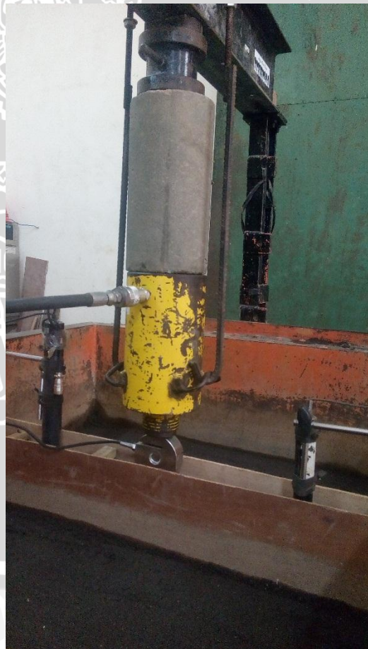
Proses pemasangan dongkrak hidraulik, load cell dan dial LVDT
