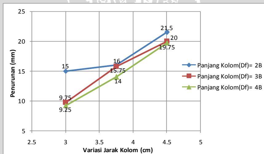
**Gambar 4.13** Grafik Hubungan Penurunan pada saat  $q_u$  terhadap Variasi Jarak Kolom
