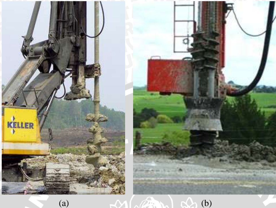
Gambar 2.7. Tipe Rakitan Auger a) Auger Rakitan Tunggal, (b) Auger Rakitan Ganda
