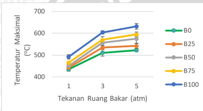
Gambar 5. Grafik pengaruh penambahan biodiesel kemiri sunan dan tekanan ruang bakar terhadap temperatur maksimal pembakaran *droplet* solar.
