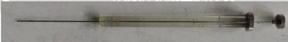
Gambar 3.1 Alat pembentuk *droplet* (*microliter syringes*)
