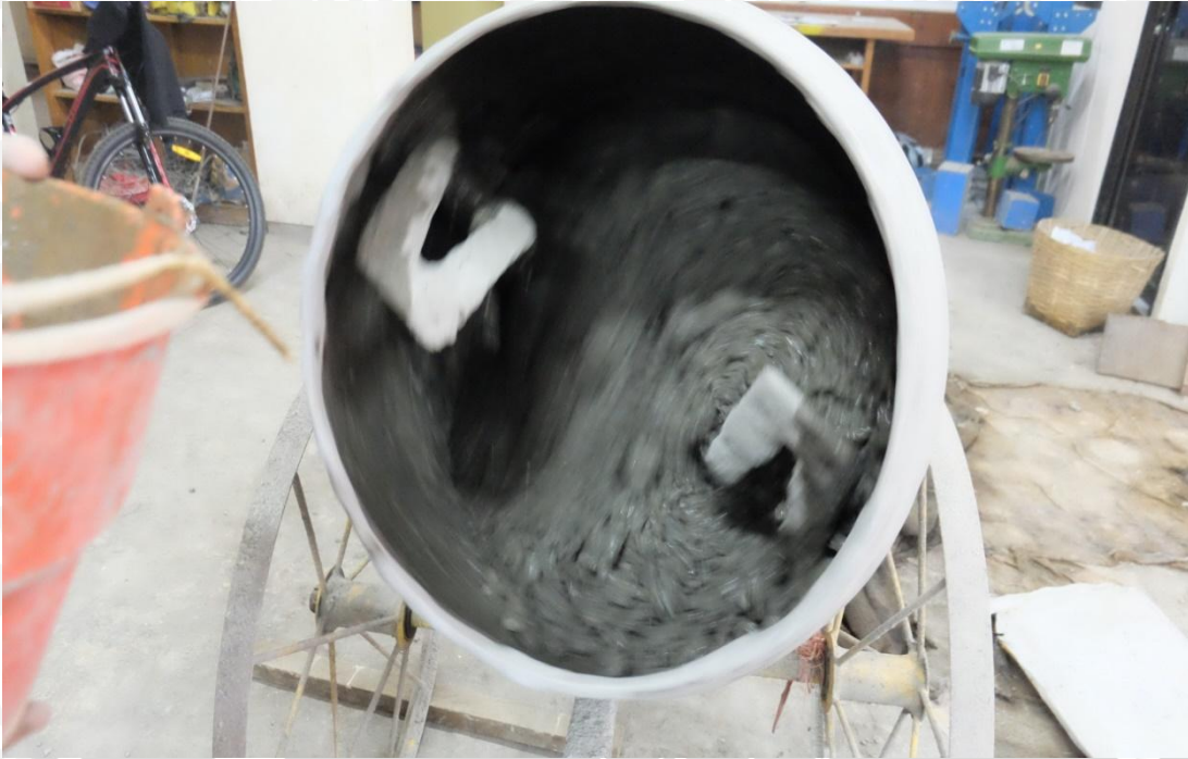
Gambar L5.7 Pencampuran Semen, Pasir, Batu Apung, Air dan Serat Bambu Pada Molen
