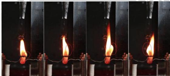
Gambar 10. Fenomena *microexplosion* pada biodieselen minyak jarak dengan 4% minyak cengkeh
