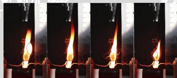
Gambar 7. Fenomena *microexplosion* pada biodiesen minyak jarak dengan 1% minyak cengkeh
