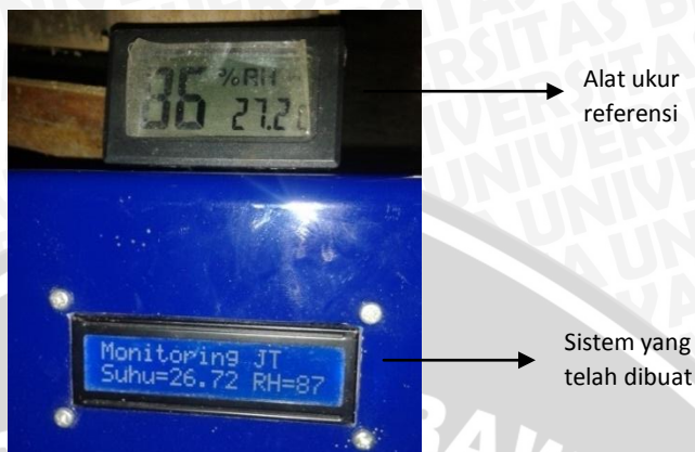
Gambar 5.1 Pengujian Akurasi Sensor SHT11
