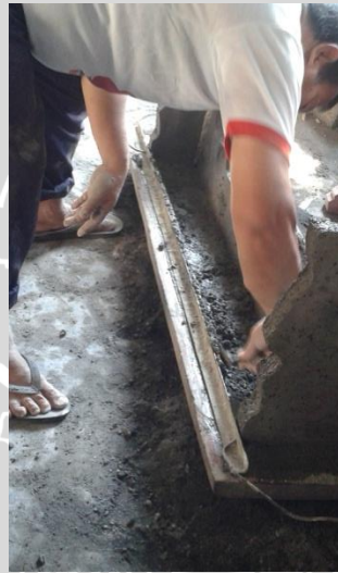
Gambar 4.28 Pembentukan lis pada tepi kursi
