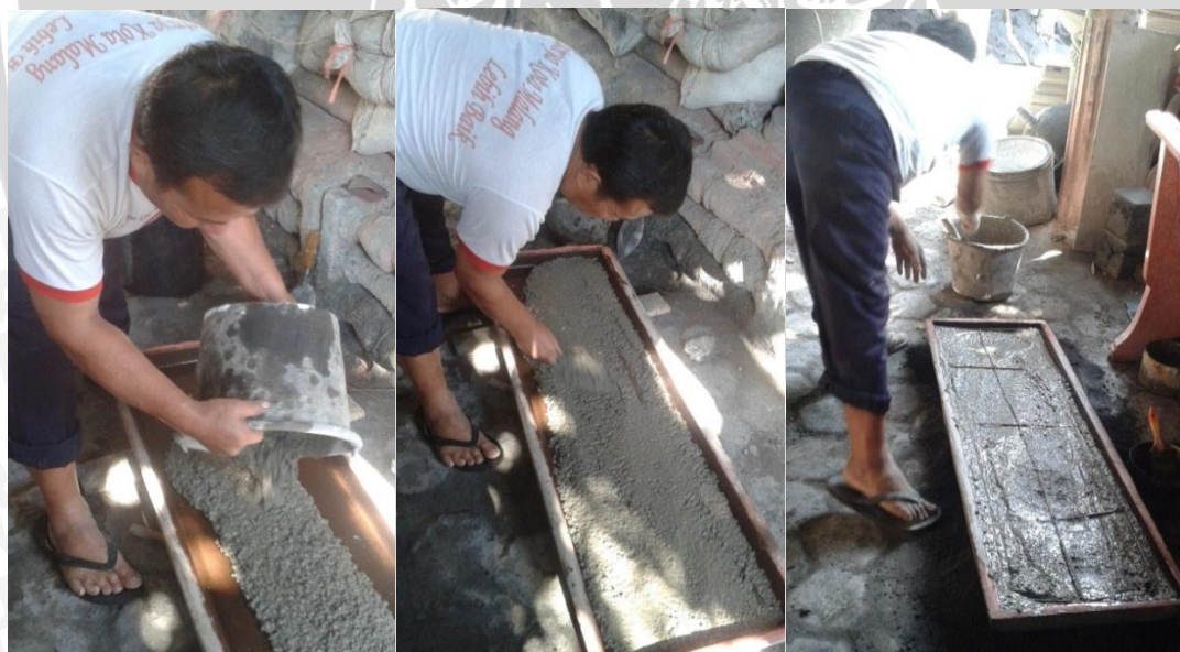
Gambar 4.24 Pencetakan bagian atas kursi teraso
