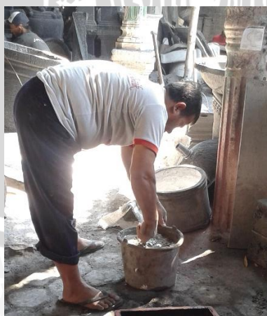
Gambar 4.13 Pencampuran bahan baku kaki dan penyangga kursi teraso
