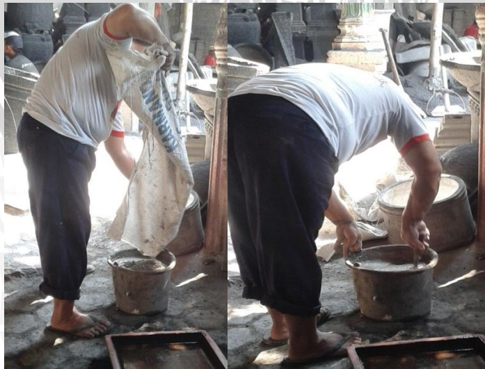
Gambar 4.22 Pencampuran bahan baku untuk bagian atas kursi teraso
