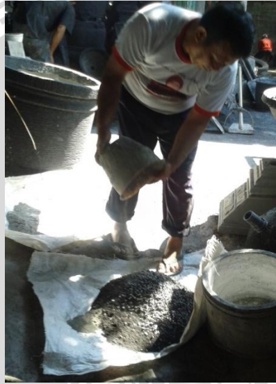
Gambar 4.21 Persiapan bahan baku untuk bagian atas kursi teraso
