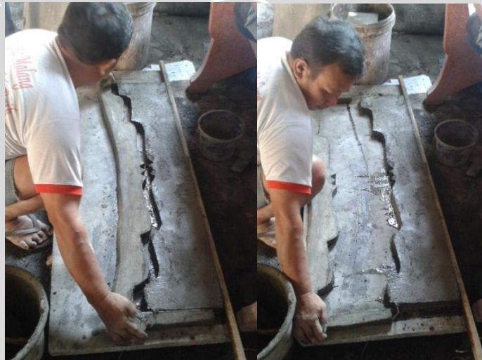
Gambar 4.18 Pelepasan kaki dan penyangga kursi teraso dari cetakan
