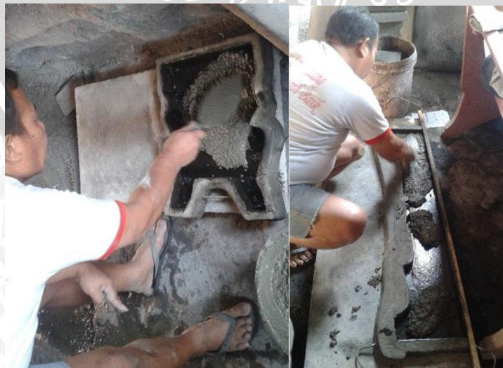
Gambar 4.16 Proses pencetakan bagian kaki dan penyangga kursi teraso
