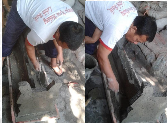
Gambar 4.27 Pelapisan ulang isi cetakan dengan adonan bahan
