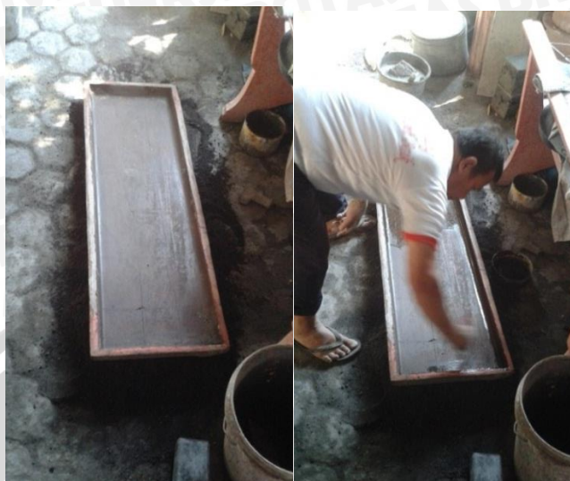
Gambar 4.23 pengolesan oli pada cetakan bagian atas kursi teraso
