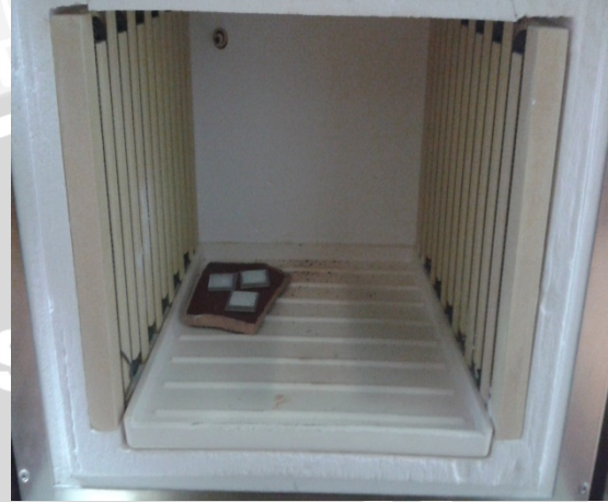
Gambar Proses Pengeringan Pasta \text{TiO}_2 pada Furnace
