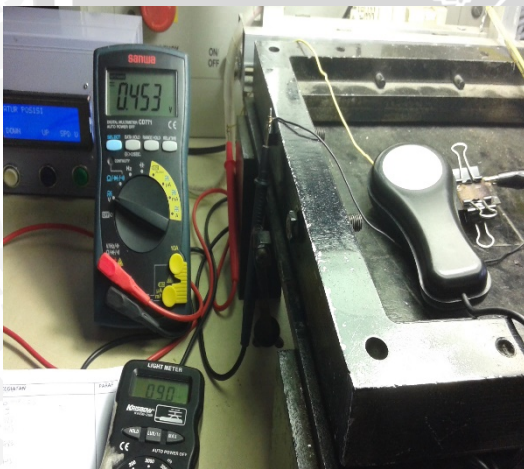
Gambar Pengujian Tegangan Sensor Optik pada Iluminasi 9000 lux
