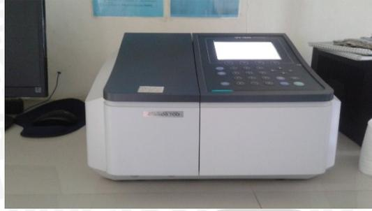
Gambar 2. 82 Spectrophotometer UV-VIS tipe UV-1800 dari Shimadzu.
