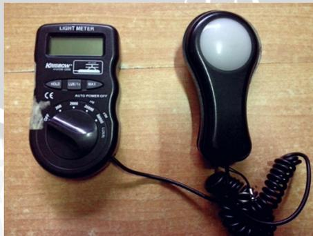
Gambar 2.13. Luxmeter KW06-228
