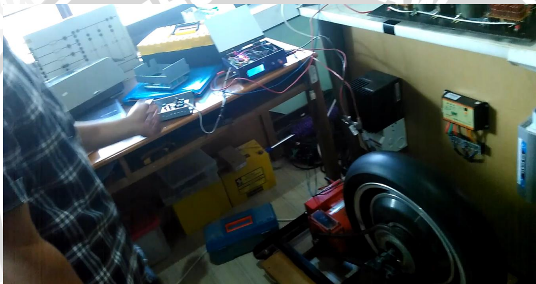
Gambar L2. 5 Proses pengujian VSI dalam mode Motoring
