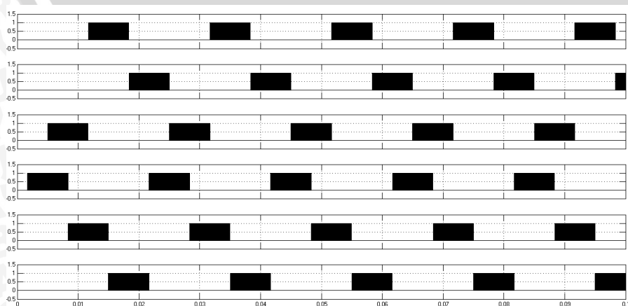
Gambar 4.22 Urutan pensaklaran S1, S3, S5, S4, S6, S2 pada mode regeneratif-plugging.
