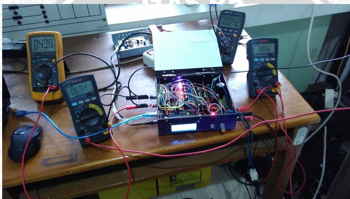
Gambar L2. 2 Proses Pengujian Regeneratif Braking System .
